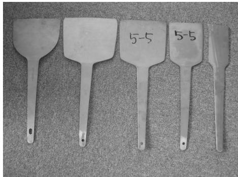
右側が最初の材料です。左にむかって行くにつれてロールの回数を増やした製品です。最初の幅が約60mmを、完成品では120mmと、2倍に伸ばします。こうして薄く延ばした材料は加工硬化（材料が硬くなる）にもなり、とても良い起し金となります。
