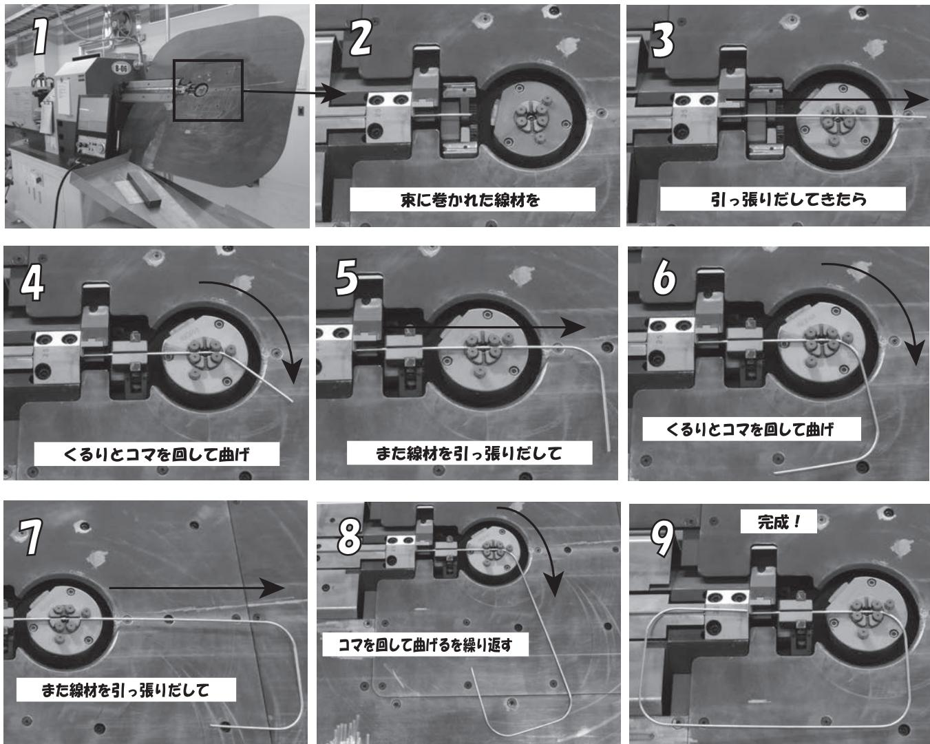
今回はバット網の枠を作っているところでした。次頁の『リング付盆ざる』も、一部このNC 3次元ベンダーを使って製造しています。
